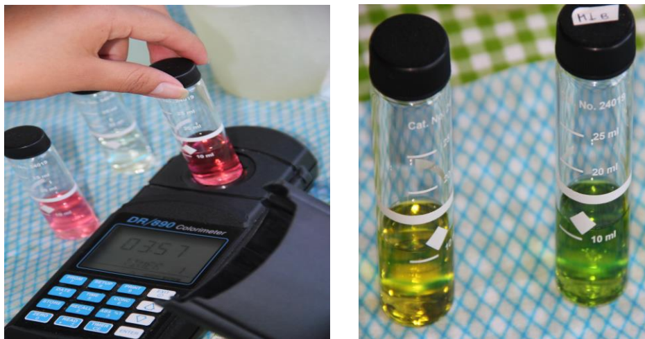
Figura 15. Determinación de nitritos (izquierda) y amonio (derecha) con el colorímetro Hach.
