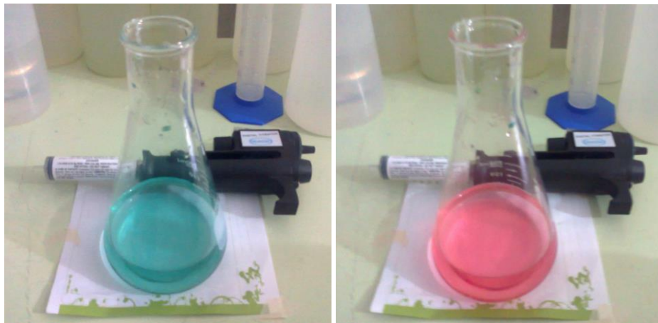
Figura 16. Determinación de la alcalinidad (izquierda) y dureza total (derecha).
